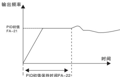
图6-27 PID初值功能示意图
