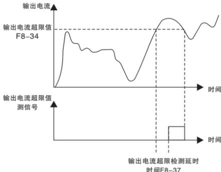
图6-22 输出电流超限检测示意图
