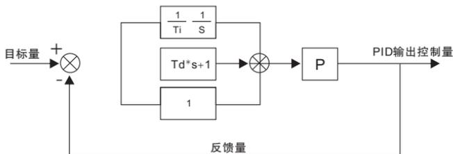
图6-25 过程PID原理框图
