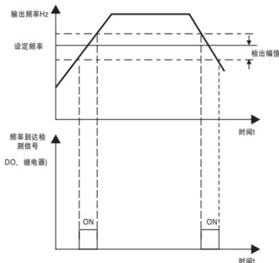
图6-14 频率到达检出幅值示意图
