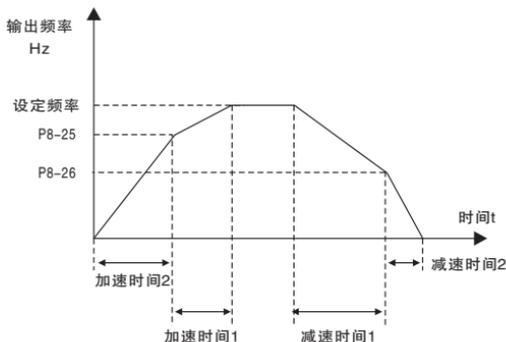
图6-19 加减速时间切换示意图
