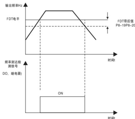
图6-16 FDT电平示意图
