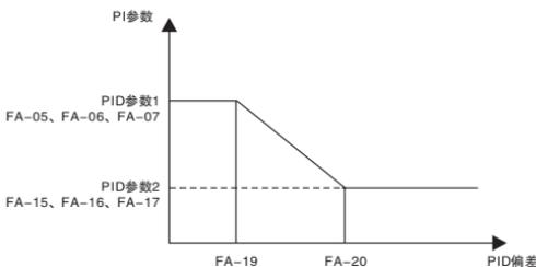
图6-26 PID参数切换
