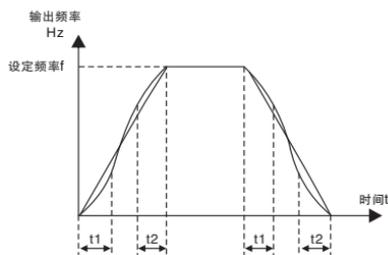
图6-11 S曲线加减速A示意图
