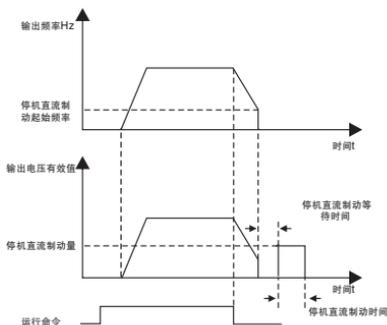
图6-13 停机直流制动示意图
