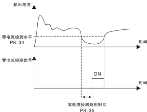
图6-21 零电流检测示意图
