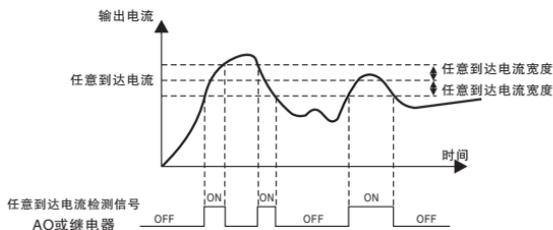
图6-23 任意到达电流检测示意图
