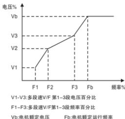
图6-4 多点V/F曲线设定示意图
