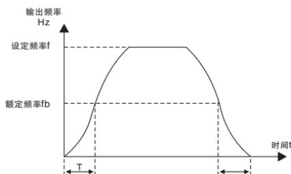
图6-12 S曲线加减速B示意图
