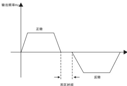
图6-15 正反转死区时间示意图
