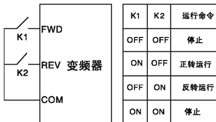
图 6-8 两线式控制（使能与方向合一）
