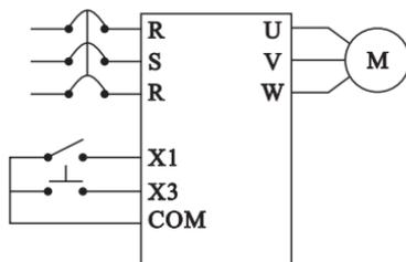
参数设定: Pr076=5、Pr000=25、Pr080=50、Pr081=30
