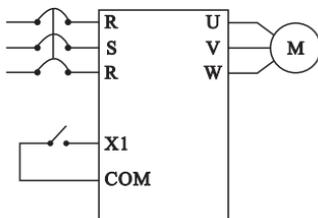
参数设定: Pr076=4 Pr000=30 Pr080=50 Pr081=30
