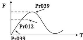
当Pr039设定为零时，S曲线无效，即以直线加减速，在不考虑失速情况下，实际加减速时间= (Pr012+CD039) / 2
