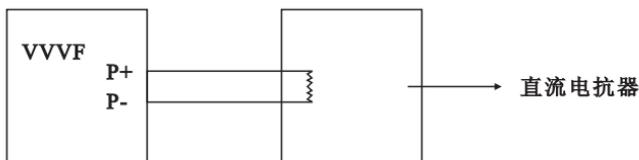
直流电抗器的用是将叠加在直流电抗器上的交流分量限定在某一规定的数值抑制电网谐波，改善变频器的功率因素。
