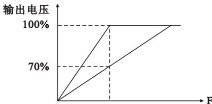
自动节能最大可降低30%的正常输出电压,对于负载变化较为频繁或已近满载运转,此功能不适用。
