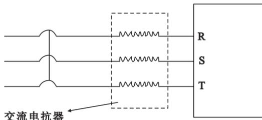
进线电抗器亦称换相电抗器，用于电网进线中
