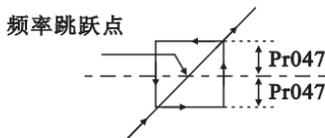
为避开机械共振点，设此三个频率跳跃点，当Pr047=0时，所有跳跃频率无效，实际跳跃频率范围为Pr047的两倍。如上图所示
