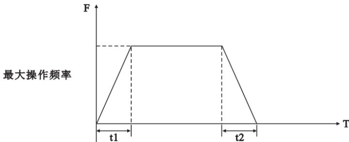
HDI系列变频器一共定义了四种加减速时间，第二加减速至第四加减速，用户可以根据需要，通过外部端子、加减速时间切换选择不同的加减速时间，在内控多段速运行中，可以通过简易PLC选择不同的加减速时间。
