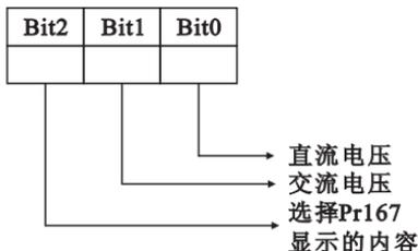
此参数设定可以选择计数器、直流高压、交流电压及变频器温度等项显示，便于用户监视，并通过切换键依次显示。
