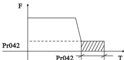
说明：此参数设定非零时，开启停止时直流制动，送入马达直流制动时间。停止时直流制动通常用于高位停车或作定位控制。
