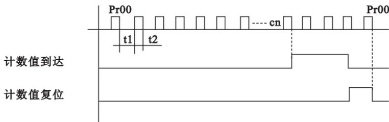
说明：(1) 触发信号宽度不得低于2msec ( $t_1$ 、 $t_2 \geq 2\text{msec}$ )；
